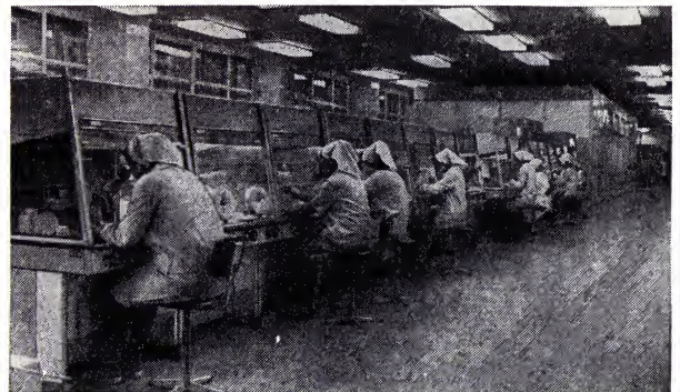
Рис. 3. Участок цеха, в котором производится чистая сборка полупроводниковых приборов.
